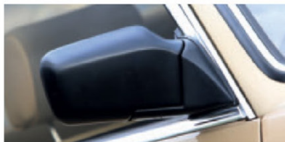
Ab Modelljahr 1980 verbaute BMW statt verchromter Außenspiegel solche aus schwarzem Kunststoff, die nun nicht mehr auf dem Türblech, sondern im Spiegeldreieck saßen.
